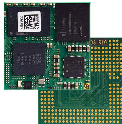
Ein CoM von F&S nach dem OSM-Standard. (Bild: F&S Elektronik Systeme)
